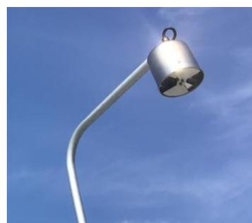
図 3 雷雲センサーのセンサー部
